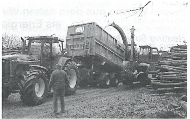
Auf einem zentralen Platz wird das vorkonzentrierte Wald-Industrieholz durch einen Mobilhacker zerkleinert und in einen landwirtschaftlichen Großkipper geblasen.
